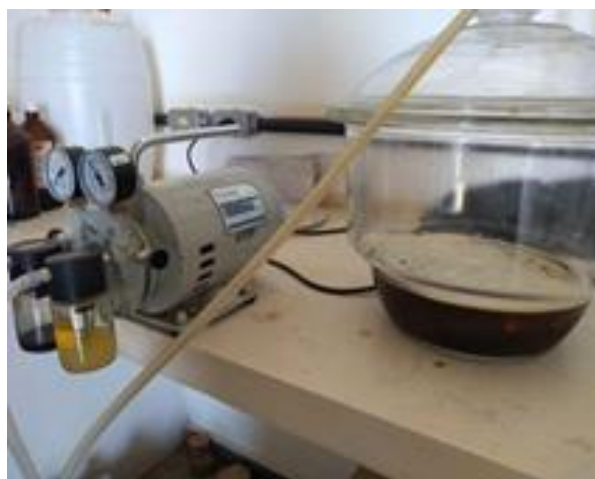
Figura 3: A impregnação dos tratamentos na madeira em bomba de vácuo.
