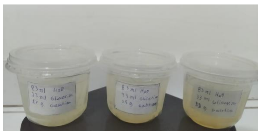
Figura 10 - Fonte: dados da pesquisa, 2021; Frascos de 100ml contendo amostras de gelatina balística feita a partir de gelatina sem sabor.
