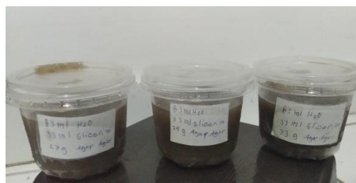
Figura 11 - Fonte: dados da pesquisa, 2021; Frascos de 100ml contendo amostras de gelatina balística feita a partir de ágar-ágar.
