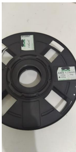
Figura 7 - Fonte: dados da pesquisa, 2021; Rolo de filamento tipo ABS.
