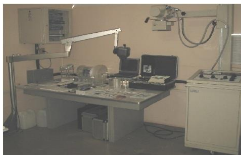
Figura 13 - Fonte: dados da pesquisa, 2021; Aparelho móvel de raios X da marca RAEX MOD. RX300 DC de 300 miliamperes (mA).
