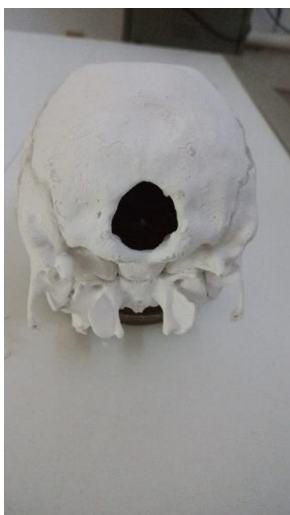
Figura 9 - Fonte: dados da pesquisa, 2021; Simulador usado na fase de teste da gelatina balística.
