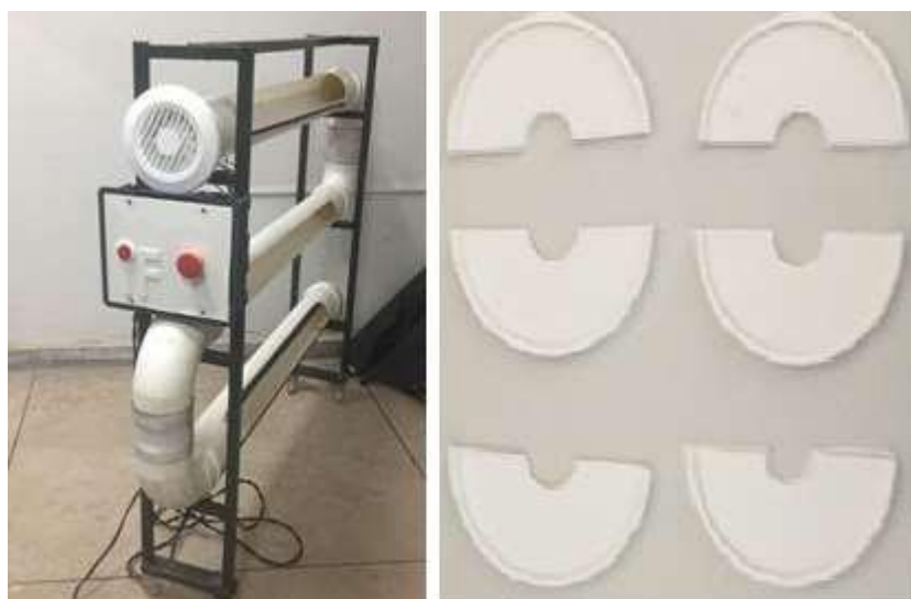
Figura 10. Painel eletroeletrônico montado (à esquerda); Anteparos (à direita).
