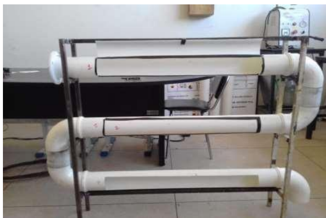
Figura 9. Montagem de tubulação e exaustor na estrutura do protótipo.
