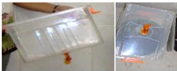
Figura 5– Torneira sob a caixa inferior, para vasão do chorume
