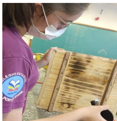
Figura 5: Queimando a caixa didática para evitar cupins.
