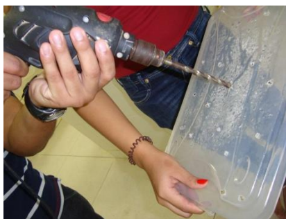
Figura 2- Realização de furos nas caixas
